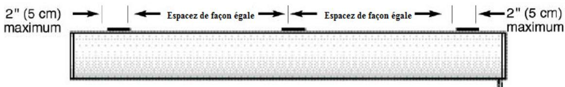
Pour une installation « murale » ou « extérieur-cadre », utilisez les trous arrière du support.
