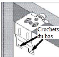
**Installez le caisson.** Posez le pan arrière du caisson (A) sur les deux crochets du bas de tous les supports. Poussez fermement l'avant du caisson vers le haut et en direction de la fenêtre jusqu'à ce que la rainure située sur le dessus du caisson s'enclenche (B) tel qu'illustré.
