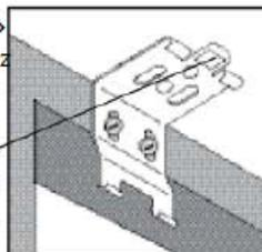
Pour une installation « au plafond » ou « intérieur-cadre », utilisez les trous du haut.
