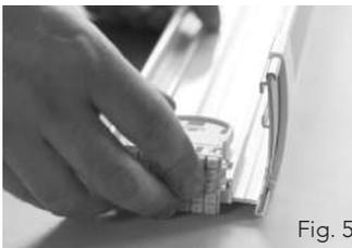
Faites glisser le bloc d'ajustement et la plaque de montage dans la cassette et remettez en place le support de levier. (Fig.4 & 5)
