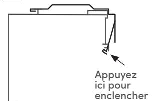
Accrochez le devant du caisson à chaque fixation, comme sur l'illustration **A**. Faites pivoter le caisson pour qu'il revienne en place et appuyez jusqu'à ce qu'il s'enclenche bien en place. (**illustration B**).
