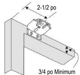
**IMPORTANT :** Si vous fixez les supports d'installation à une cloison sèche, veillez à utiliser des ancrages muraux et à suivre les instructions fournies avec les ancrages. (Ancres non fournies).
