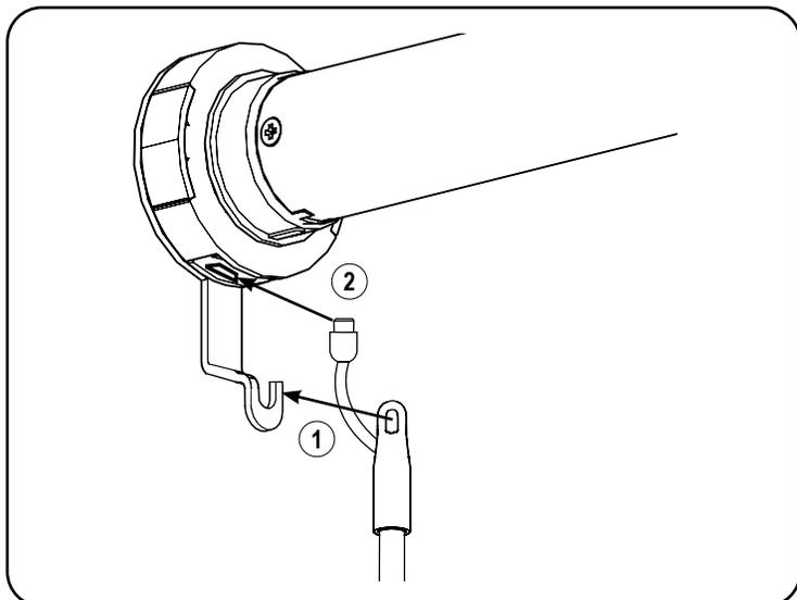
Sur les stores doubles, les stores à enrouleur et les stores translucides, les boutons de commande de la baguette étant tournés vers vous, fixez le haut de la baguette sur le support de crochet en métal (1) du côté de la commande du moteur, puis connectez le câble dans la tête du moteur (2).
