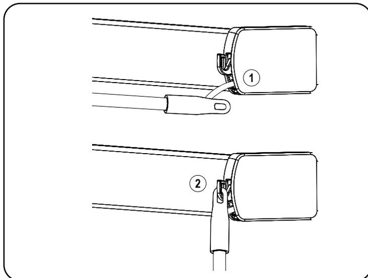
Sur les stores alvéolés, la baguette sera déjà connectée au store (1). Avec les boutons de commande de la baguette étant tournés vers vous, fixez le haut de la baguette dans le support de crochet en plastique du côté de la commande du moteur (2).
