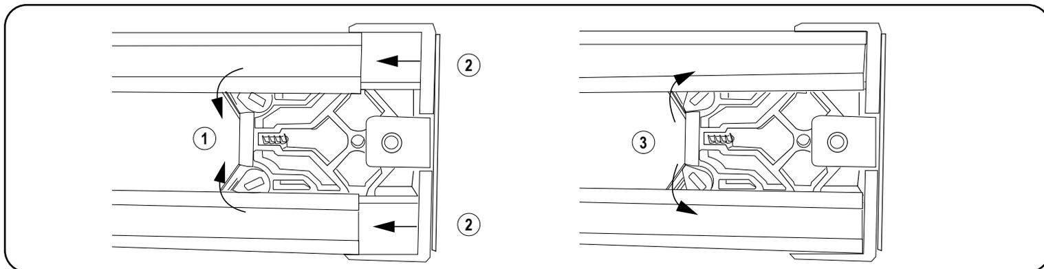
Le capuchon d'extrémité mobile est conçu pour être retiré facilement et sans outil. Si, pour une raison quelconque, le capuchon d'extrémité doit être comprimé, vous aurez besoin d'un petit tournevis à tête plate. (1) Utilisez le tournevis pour tourner les vis de déblocage de la languette de verrouillage comme indiqué. (2) Pousser le capuchon d'extrémité vers l'intérieur. (3) Remettre les languettes de verrouillage dans leur position d'origine.
