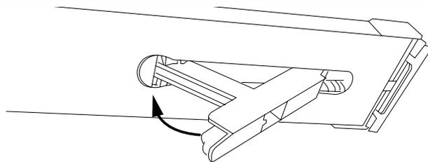
Assurez-vous que le système de montage est de niveau. Appuyez sur le levier pour verrouiller le système de montage en place.
