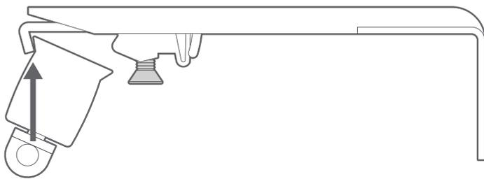
Placez la languette avant du caisson du rideau dans le crochet avant du support.
