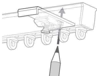
Ensuite, placez le rail sur la surface d'installation et marquez l'emplacement des trous de vis à l'aide d'un crayon.
