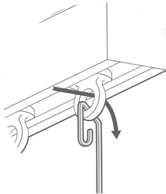
Insérez les crochets dans les œillets en plastique du caisson.
