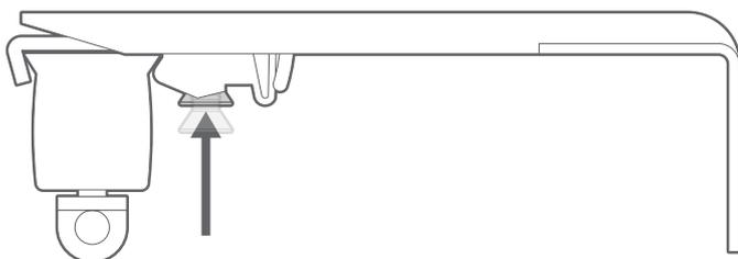
Serrez la vis de blocage du support pour bien fixer le rail.
