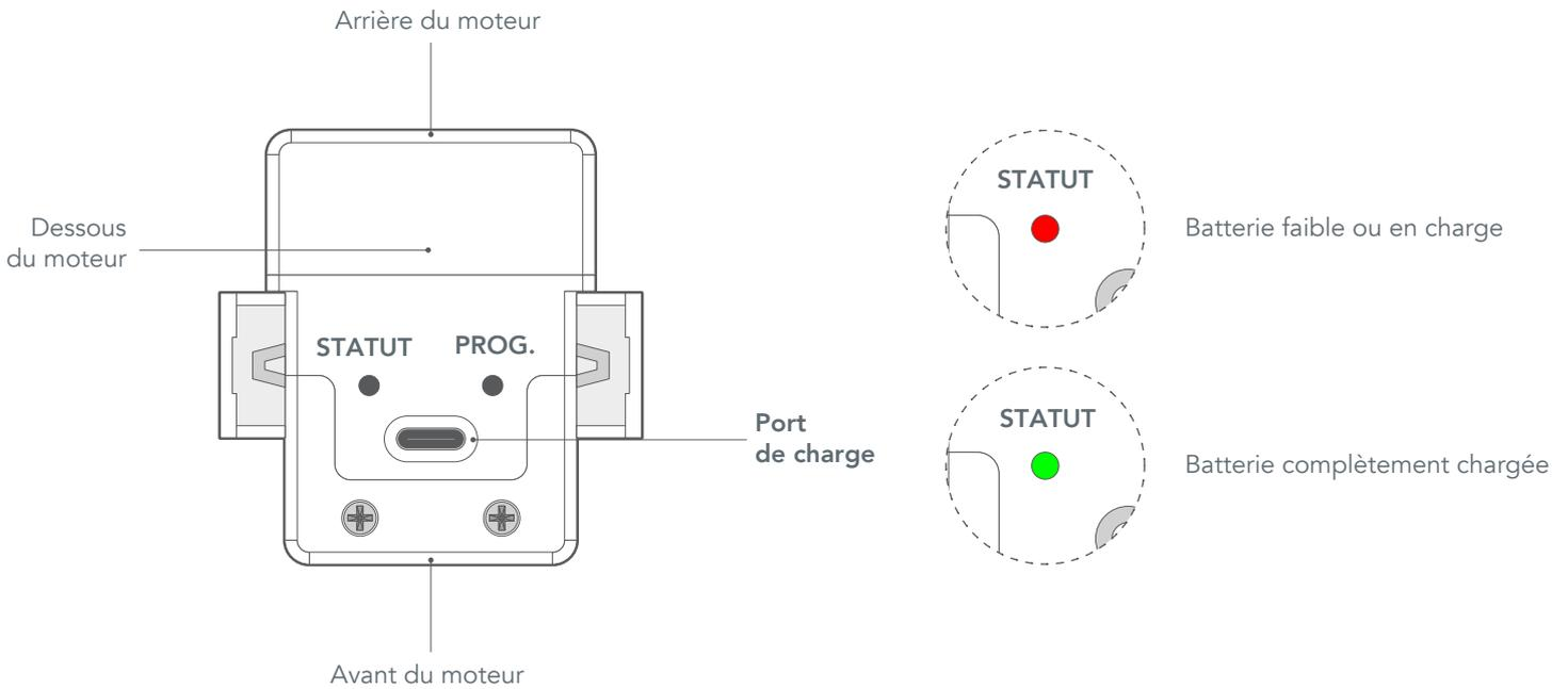
Un port USB-C se trouve en-dessous du moteur. Pour recharger la batterie du moteur, branchez tout simplement le câble dans le port de chargement. Lorsque la batterie est complètement déchargée, il faut compter environ 8 heures pour qu'elle se recharge entièrement. Pendant la charge, le voyant STATUT situé sous le moteur sera rouge, puis passera au vert lorsque la batterie sera complètement chargée.
