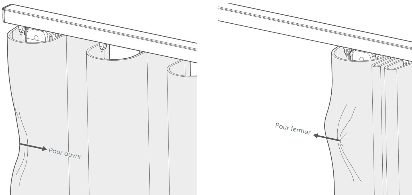
Pour ouvrir les rideaux une fois le moteur installé, il suffit de tirer « d'un petit coup sec » dans la direction où vous souhaitez qu'ils s'ouvrent. Le moteur détectera alors le mouvement et se mettra à faire bouger les rideaux jusqu'à ce qu'ils soient complètement ouverts. Pour fermer les rideaux, tirez tout simplement le côté conducteur dans la direction opposée.
