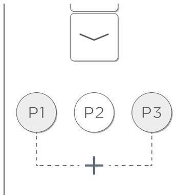
Appuyez en même temps sur les boutons P1 et P3 et maintenez-les enfoncés jusqu'à ce que le moteur fasse un petit mouvement saccadé. Le moteur est désormais en mode configuration.
