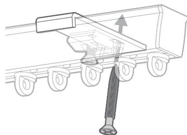
Percez un trou à chaque endroit marqué au crayon et insérez des chevilles. Placez ensuite le rail et les supports à l'endroit et fixez les supports avec les vis. Utilisez une seule vis par support en l'insérant dans le trou situé le plus à l'arrière.
