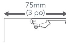
Si vous utilisez des supports de fixation par le haut, le rebord avant de vos supports devrait se trouver à au moins 75 mm (3 po) de la surface qui se trouve à l'arrière du rail. Cette position vous assurera que le tissu ne frottera pas contre le mur ou la fenêtre qui se trouve derrière.
