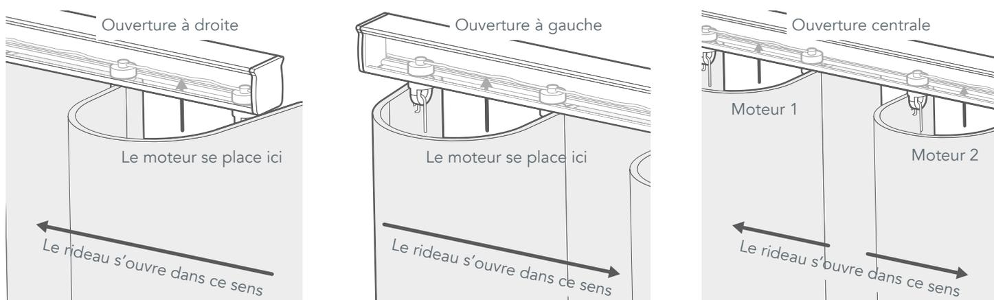
Le moteur se placera sur le rail, derrière le rideau, entre les deux derniers œillets du bout. Pour les rideaux s'ouvrant par le centre, vous devrez fixer deux (2) moteurs, c'est-à-dire un (1) à chaque extrémité, entre les derniers œillets du bout.
