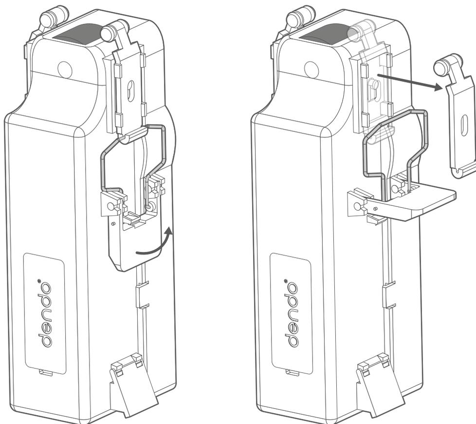
Détachez tout d'abord l'une des glissières se trouvant sur le dessus du moteur. Soulevez l'attache de la glissière, puis tirez tout simplement pour la libérer de son support situé sur le côté du moteur.
