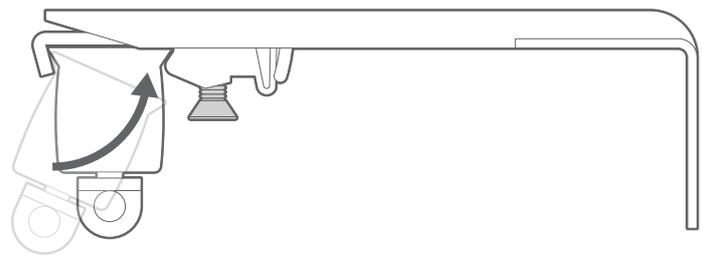
Faites pivoter le caisson de façon à ce que la languette arrière vienne s'enclencher dans la partie arrière du support, puis resserrer la vis du support afin de bien fixer le rail.
