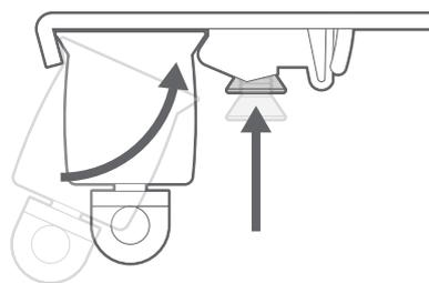
Faites pivoter le caisson de façon à ce que la languette arrière vienne s'enclencher dans la partie arrière du support, puis resserrer la vis du support afin de bien fixer le rail.
