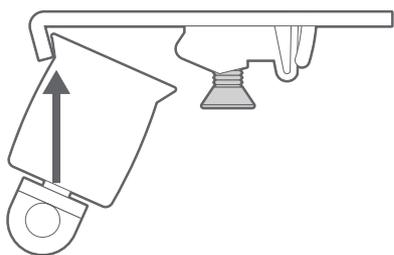
Pour ce faire, placez la languette avant du caisson dans le crochet avant du support.
