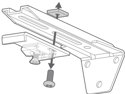
Détachez la partie supérieure du support de la partie en forme de « L ».
