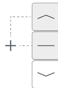
Maintenez enfoncés les boutons OUVRIER et ARRÊTER jusqu'à ce que le moteur fasse un petit mouvement saccadé. Le moteur est désormais supprimé du canal.
