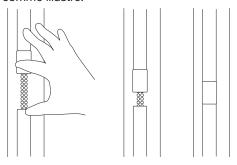
Faites glisser la section inférieure du couvercle de chaîne dans le connecteur pré-attaché à la section supérieure.
