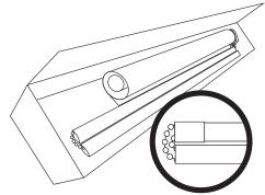
La couverture des stores plus grands sera composée de deux sections qui sont séparées lorsque le store est emballé pour l'expédition et doivent donc être assemblées lorsque le store est installé. Voir les instructions complètes ci-dessous :
